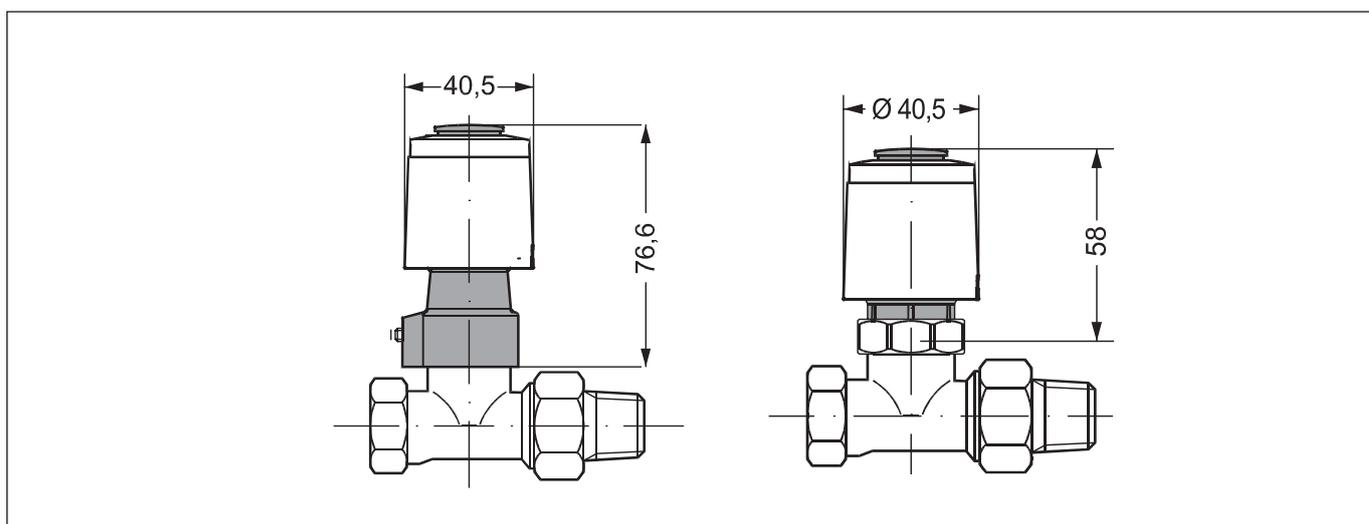
**Внимание!** Все нормально закрытые термоэлектрические приводы перед монтажом должны быть приведены в открытое положение (красный фиксатор установлен на привод) для их легкой установки на клапан.
